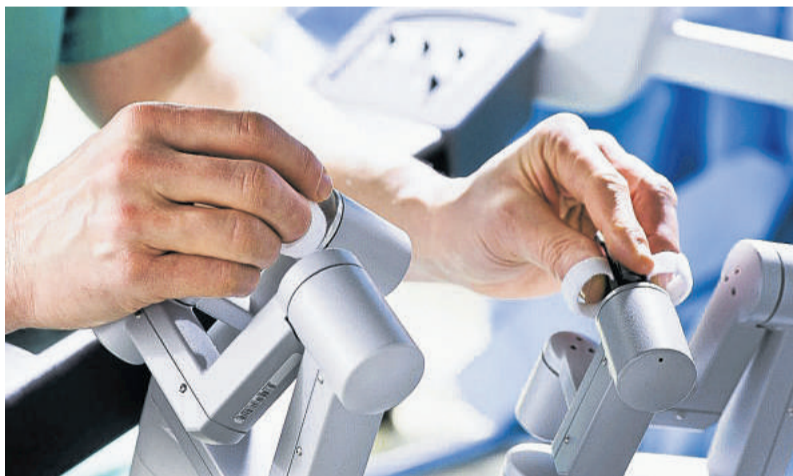
Steuerung im OP: Schere, Pinzette und Co werden über Griffschlaufen bewegt. Das Handgelenk hat dabei viel Bewegungsfreiheit – so kann der Chirurg präzise arbeiten.
