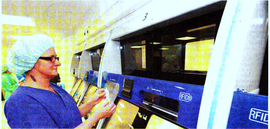
Alles in einem Abwasch: In der neuen Augusta-Zentrale (hier Mitarbeiterin Wasilewska Wieslawa) werden OP-Bestecke und Endoskope gereinigt und sterilisiert. Jeder Arbeitsgang wird elektronisch erfasst und in einem ausgedruckten Protokoll dokumentiert. Foto: Karl Gatzmanga
