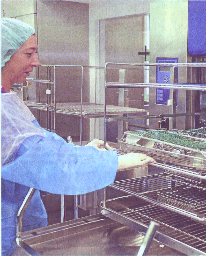
Möglichst 100 Prozent keimfrei: Auf der einen Seite werden die OP- und endoskopischen Geräte in die Reinigungsmaschinen geladen (l.), in einem abgetrennten Raum werden sie nach der Reinigung entnommen (u.r.). Übertragung von Keimen durch die Luft kann ausgeschlossen werden. Die Maschine dokumentiert zudem, welche Geräte wie gereinigt wurden (o.r.). RN-Fotos (4) Reichel
