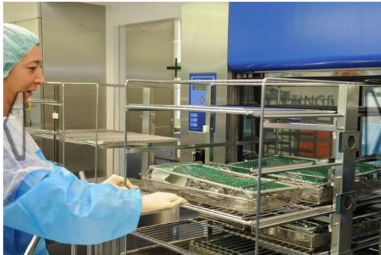
1/2 Auf einer Seite werden die OP- und endoskopischen Geräte in die Reinigungsmaschine geladen. (Foto: Benedikt Reichel)
